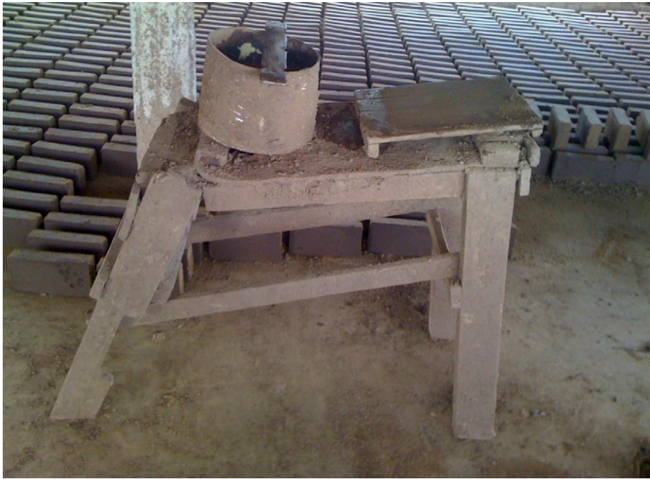
Figura 8. En la galera de tabiques. Burro de trabajo donde se moldean las formas rectangulares de los ladrillos o tabiques rojos, en una galera de la familia Caballero. Detrás, una tanda está puesta a secar antes de meterla al horno.
