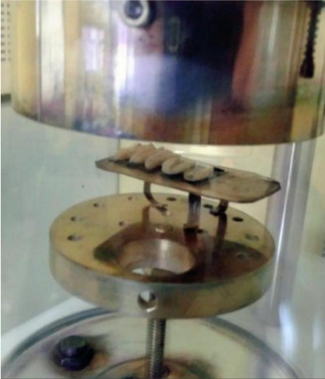
**Imagen 2.** Montaje en la platina de cobre con cinta adhesiva de carbón.
