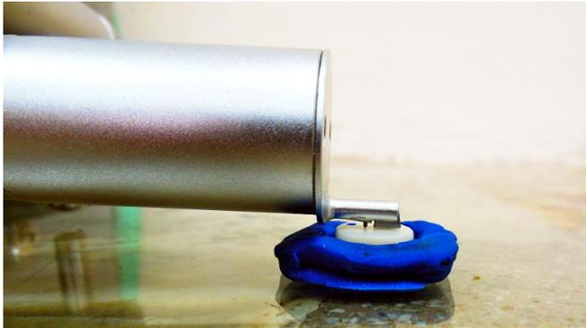
**Imagen 2.** Punta diamantada del perfilómetro realizando las mediciones en una muestra. La superficie de la muestra debe estar perpendicular a la punta.
