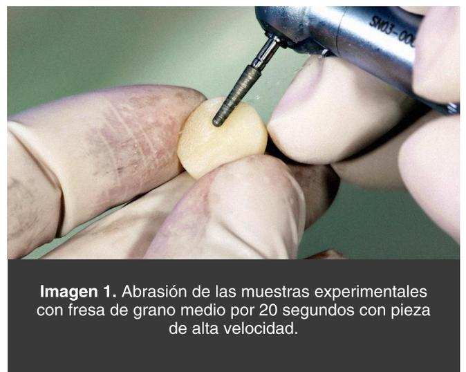
**Imagen 1.** Abrasión de las muestras experimentales con fresa de grano medio por 20 segundos con pieza de alta velocidad.
