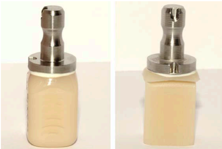
Figura 1. Bloque antes (izquierda) y después (derecha) del fresado en CAD/CAM
