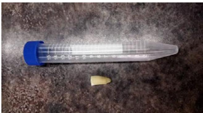
**FIGURA 6.** ENSAMBLAJE DE LA MUESTRA AL TUBO FALCÓN
