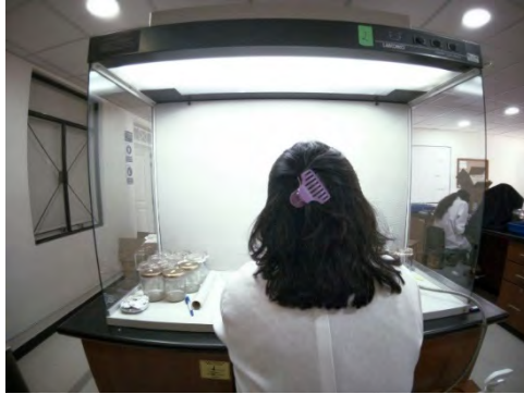
Figura 2. Área de trabajo (cámara de flujo laminar) para el cultivo in vitro de plantas
