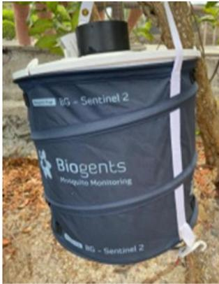
**FIGURA 6.** Trampa BG colocadas en zonas urbanas y suburbanas para captura de mosquitos. Estas trampas operan con una batería que debe ser recargada y las muestras se recogieron a diario
