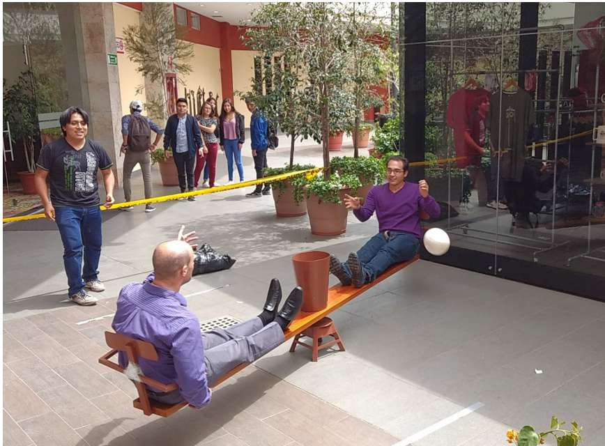
FIGURA 1. Experimento presentado en la Casa Abierta de Física 2018 para estudiar el efecto Coriolis. La trayectoria de la bola se ve afectada debido a la rotación del sistema.
