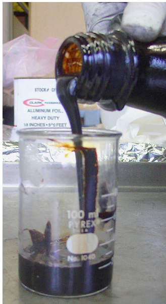
Figura 10. Alquitrán generado por pirólisis.
