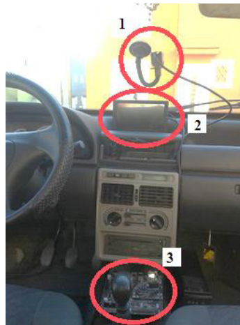
FIGURA 4. Sistema de detección de señales de tráfico del Ecuador, en los casos Pare y Ceda el paso.
