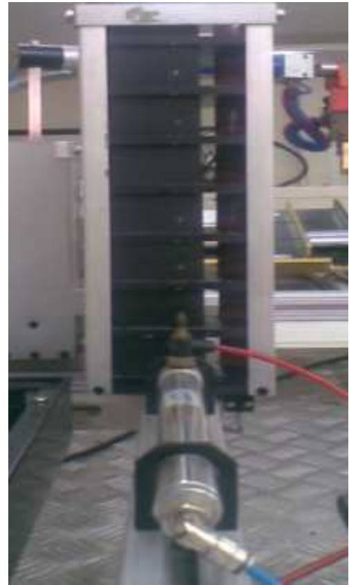
Figura 4: Almacén de paletas ST-02
