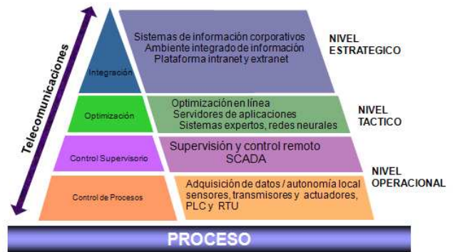
Figura 1: Pirámide de Automatización Industrial
