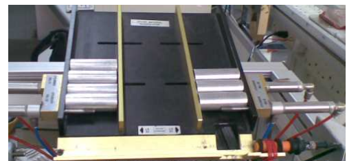
Figura 5: Almacén de cilindros LS-01/02
