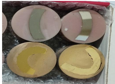
Figura 11. Muestra metalográfica recubierta con oro para observación SEM, preparadas según la Norma ASTM E3-11.
