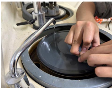
Figura 8. Proceso de pulido de las muestras metalográficas.
