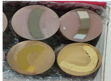
Figura 11. Muestra metalográficas recubiertas con oro para observación SEM, preparadas según la Norma ASTM E3-11.
