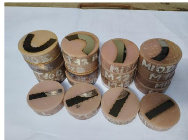
Figura 9. Muestras metalográficas preparadas conforme a la Norma ASTM E3-11, sin ataque químico.
