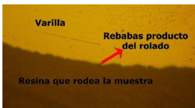
Figura 16. Micrografía metalográfica de muestra patrón (tramo recto), varilla de 10 mm.
