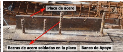
Figura 3. Estribadera utilizada en el doblado tradicional de varillas de acero de 12 mm.
