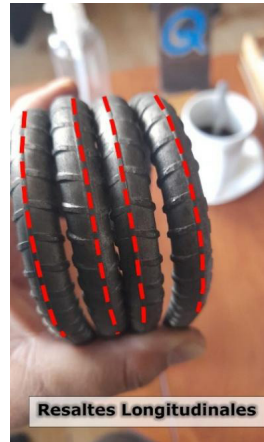
Figura 7. Varillas dobladas mediante dobladora semiautomática, mostrando la alineación del doblez sobre el resalte longitudinal.
