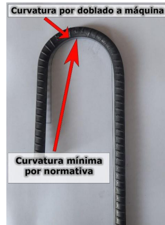
Figura 15. Varillas de 12 mm doblada mediante máquina semiautomática.
