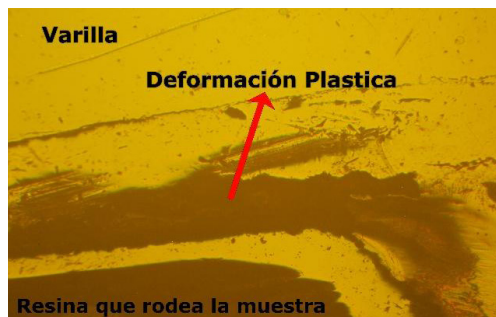
Figura 23. Deformación plástica en la zona interior del doblez de una varilla doblada mediante el método tradicional.
