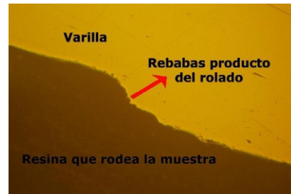
Figura 19. Micrografía metalográfica de varilla de 12 mm doblada a máquina.
