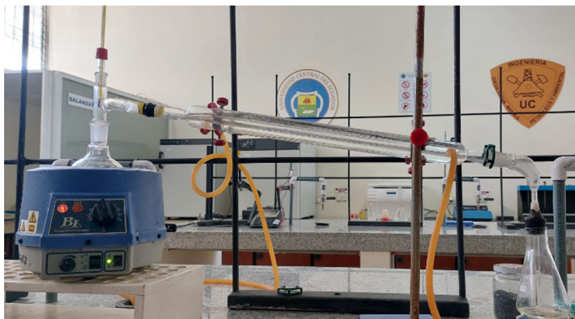
FIGURA 8. Sistema de destilación.
