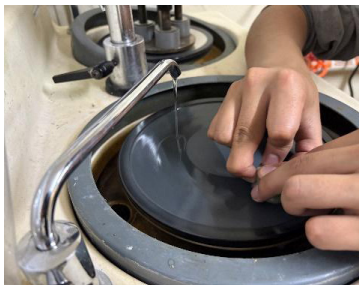
Figura 8. Proceso de pulido de las muestras metalográficas.
