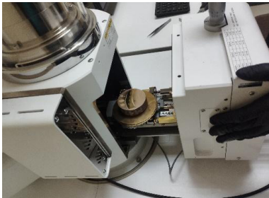
Figura 10. Muestra colocada en la cámara de vacío del microscopio electrónico de barrido (SEM).
