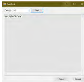
Figura 9. HiPS no encontró ningún bloqueo o punto muerto en la simulación del modelo de Petri
