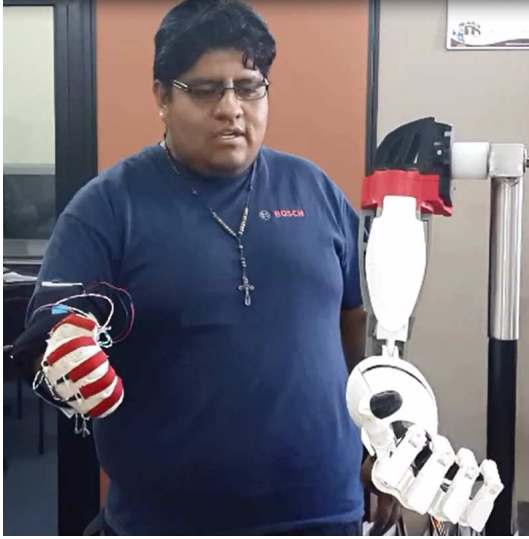
Figura 3: Verificación de los grados de movimientos.
