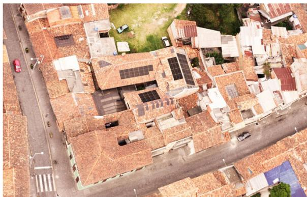
**Figura 7:** Edificaciones con montaje de placas requeridas para alcanzar el estándar Net-Zero de alto consumo (Esteban Zalamea-León / Antonio Barragán-Escandón [39])
