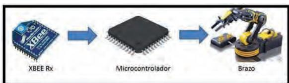
Figura 4: Proceso de recepción de instrucciones y ejecución por parte del brazo robótico.
