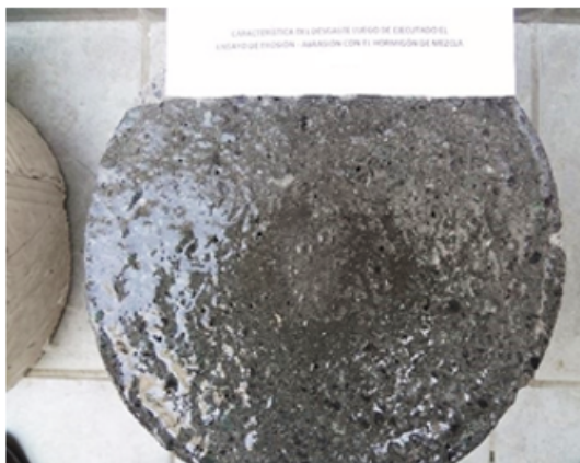
Figura 8: Probeta de mezcla 4 luego del ensayo erosión abrasión.
