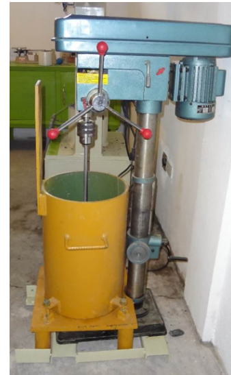
Figura 7: Equipo utilizado para pruebas de erosión abrasión.
