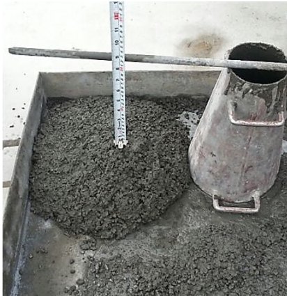
Figura 5: Revenimiento típico en muestras de la mezcla 4.
