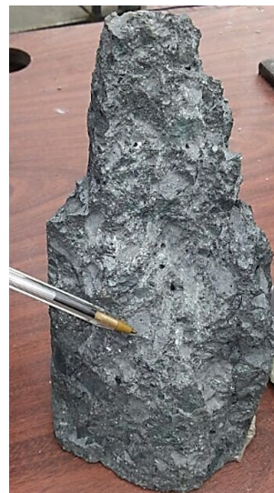
Figura 9: Superficie de falla de cilindro de prueba a compresión (mezcla 4).
