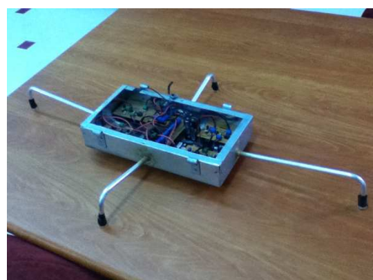
Figura 7: Montaje final del sistema de localización por ultrasonido.
