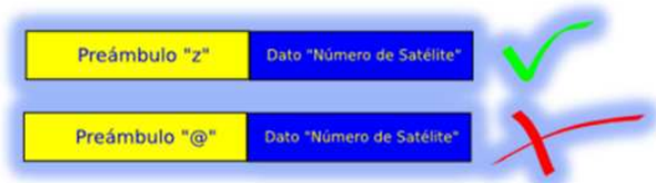
Figura 3: Trama de protocolo de comunicación de radiofrecuencia entre transmisor y receptor.
