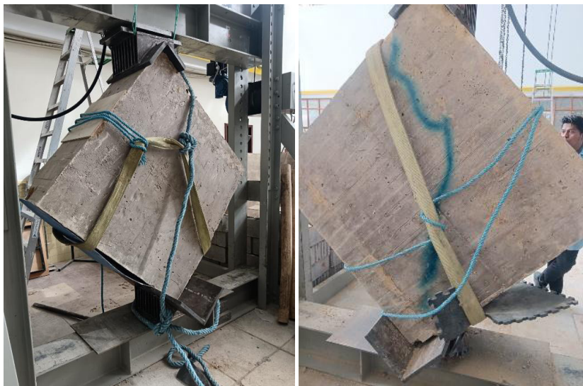
A Colocación del murete para el ensayo.
