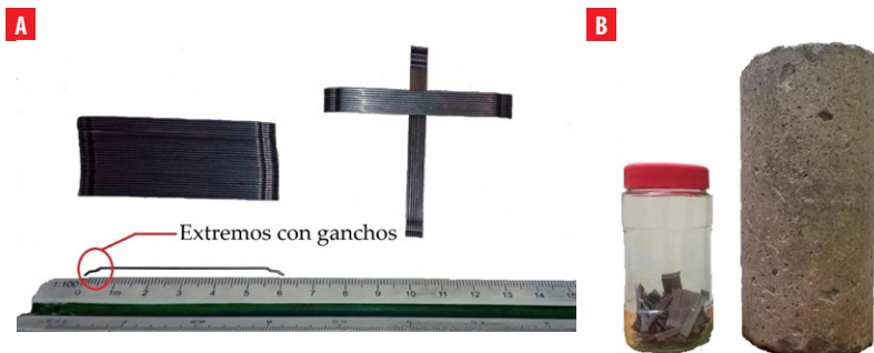
FIGURA 1. Fibras de acero: A Características geométricas de las FA ( L/d = 65 ); B Volumen de FA añadido a un cilindro de concreto.
