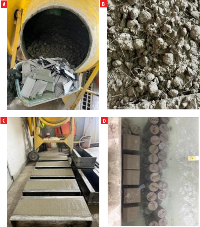
FIGURA 2. Fabricación de muestras: A Adición de FA. B Mezcla de concreto en su etapa fresca. C Colado de la mezcla en elementos prismáticos, D Curado de los especímenes en agua potable para ensayos destructivos.
