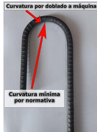
Figura 15. Varillas de 12 mm doblada mediante máquina semiautomática.
