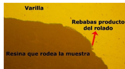
Figura 17. Micrografía metalográfica de muestra patrón (tramo recto), varilla de 12 mm.
