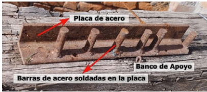
Figura 2. Estribadera utilizada en el doblado tradicional de varillas de acero de 10 mm.
