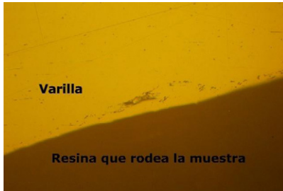
Figura 18. Micrografía metalográfica de varilla de 10 mm doblada a máquina.
