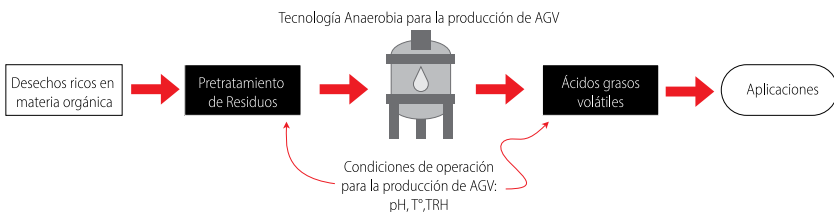
Figura 1. Esquema del proceso de conversión de residuos agroindustriales en ácidos grasos volátiles (AGV).
