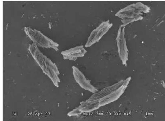
Figura 4: Imagen obtenida por microscopía electrónica de barrido (SEM) de partículas de MAC-P.
