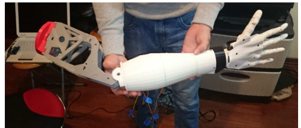
Figura 16: Brazo con la cubierta de los servomotores.
