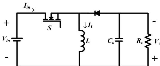
Figura 3: Circuito esquemático, convertidor reductor-elevador.
