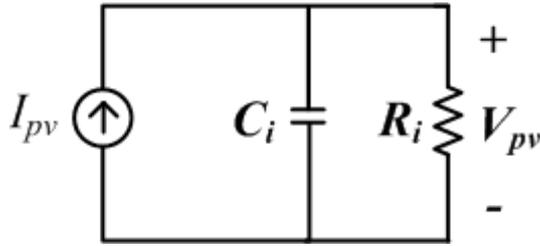
Figura 5: Circuito equivalente en la región fuente de corriente.
