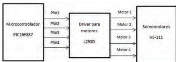
Figura 7: Electrónica empleada entre PIC y motores.
